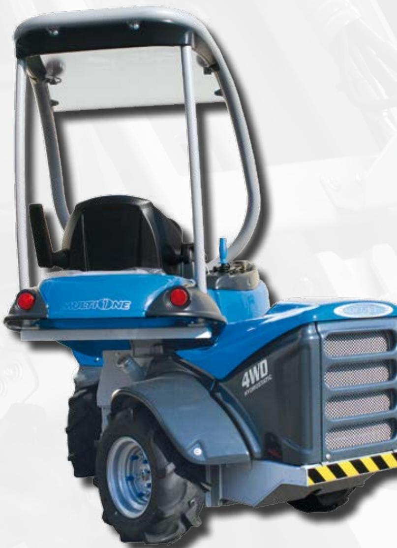
Полный привод (4WD - 4-wheel drive) обеспечивает максимальное сцепление даже на сложной местности и в сложных условиях, а самоблокирующийся дифференциал (DBS - dynamic block system) помогает при работе на мягкой почве, не повреждая ее.
